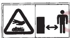
При работе электростанции глушитель становится очень горячим и остывает некоторое время после ее выключения. Будьте внимательны и не дотрагивайтесь до глушителя, пока он горячий. Дайте двигателю остыть до того, как поставить его на хранение в помещение.
