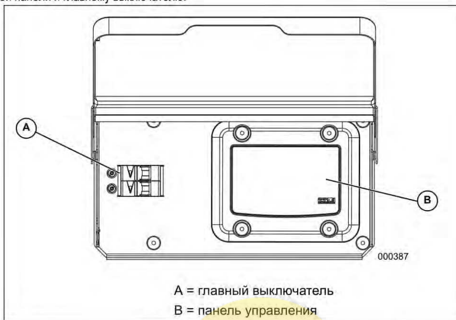
Рис. 3-3. Расположение панели управления и главного выключателя
